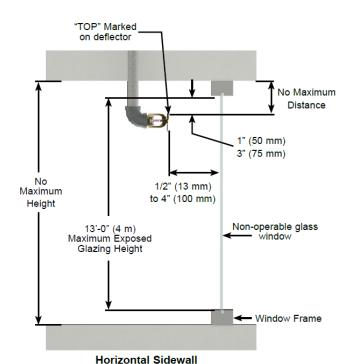
FIGURE 3—HORIZONTAL SIDEWALL SPRINKLER INSTALLATION
